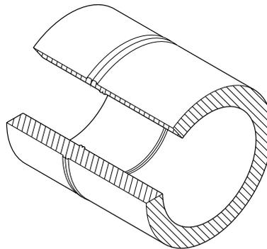
*Condition-* Weld bead uneven.
